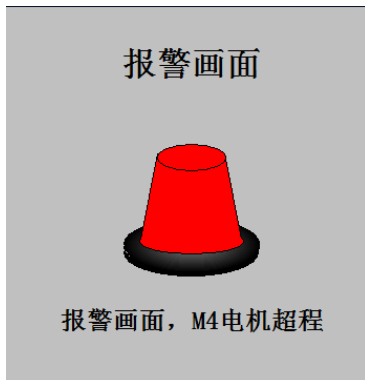
图6 M4电机超程画面
