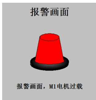
图4 M1电机过载画面
